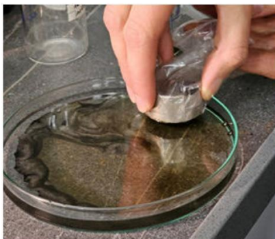
Рисунок 13. Сбор нефти наночастицами магнетит@ОК ( олеиновая кислота)
